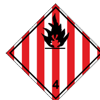
Klasse 4.1 - Entzünd- bare feste Stoffe, selbst- zersetzliche Stoffe und desensibilisierte explo- sive feste Stoffe
